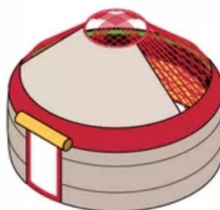
پوشیدن قسمت جلوی سقف با اوزوک و بستن آن با اوزوک بوو به قیرچوو
